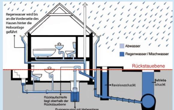
Rückstausicherung durch Einbau einer Hebeanlage
